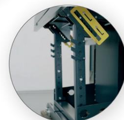
**LIFT**, für das einfache Laden der Stangen mit einem Wagen oder Portalkran
