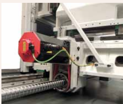
■ Motori assi in presa diretta per riduzione giochi. Feststehende Kugelumlaufspindel ab X-Verfahrweg 2.500 mm, verhindert Schwingungen und Vibrationen.
