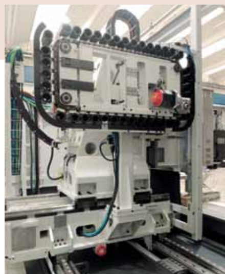
■ Magazzino utensili collegato al montante, riduce i tempi di cambio utensile.
