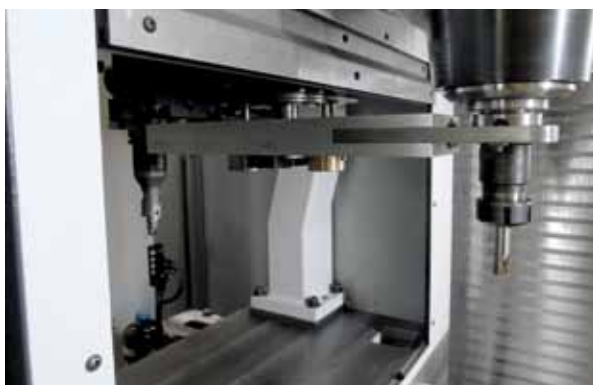
■ Braccio cambio utensili. Doppelarm-Werkzeugwechsler
