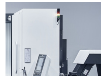
Dreifarbige Signalleuchte mit akustischer Signalgebung.
