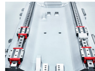
Die Bewegungen der Achsen X/Y/Z erfolgen über Linearführungen mit vorgespannten Rollenschuhen mit doppelten Rücklauf, die eine schnelle und präzise Positionierung garantieren (Wartungsfreies System).
